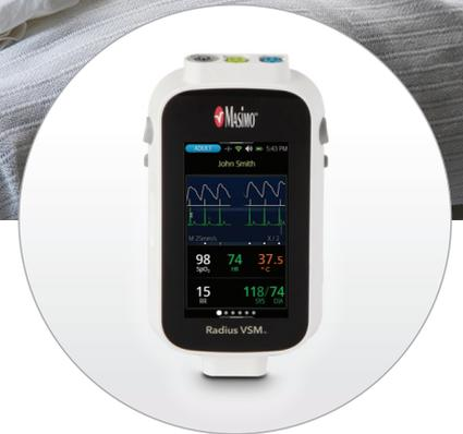
Der Radius VSM ist ein am Körper getragener Vitaldatenmonitor, der eine breite Palette physiologischer Messungen ermöglicht. Radius VSM basiert auf einer modularen Plattform und kombiniert die Zuverlässigkeit und Genauigkeit eines bettseitigen Monitors mit dem Komfort und der Freiheit eines tragbaren Geräts, das Mobilität und Bewegung ermöglicht und zugleich sicherstellt, dass der Patient kontinuierlich und ohne Unterbrechung überwacht wird.
