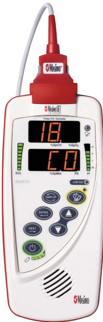
Die Abbildung zeigt Rad-57, das SpCO anzeigt. Anzeigemerkmale sind je nach den auf dem Gerät geladenen nicht-invasiven Messungen verschieden.
